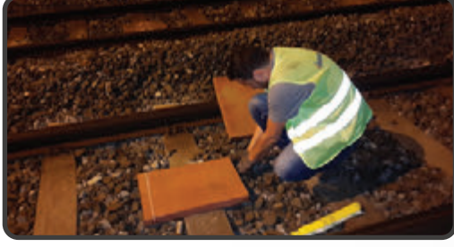
Test Ön Hazırlığı, Balis Antenlerin Örtülmesi
